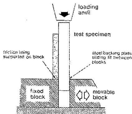
**Lining 'Push-Off' Shear Test**
